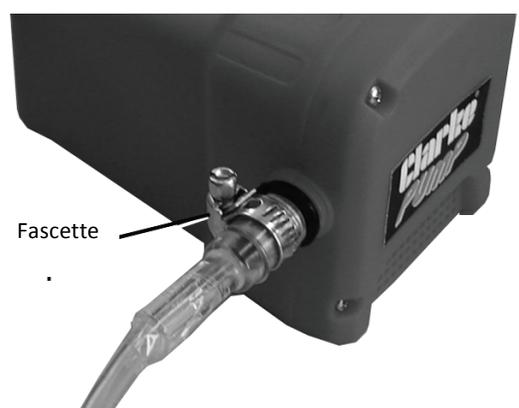
3. Inserire i tubi di aspirazione e mandata nel motore e in un contenitore appropriato per l'olio di scarto.
