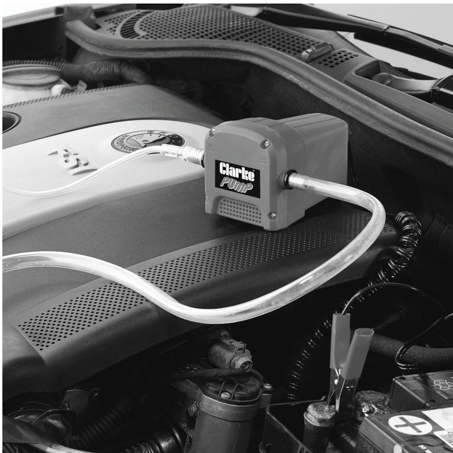
Collegare la pompa esclusivamente a una batteria a 12V
